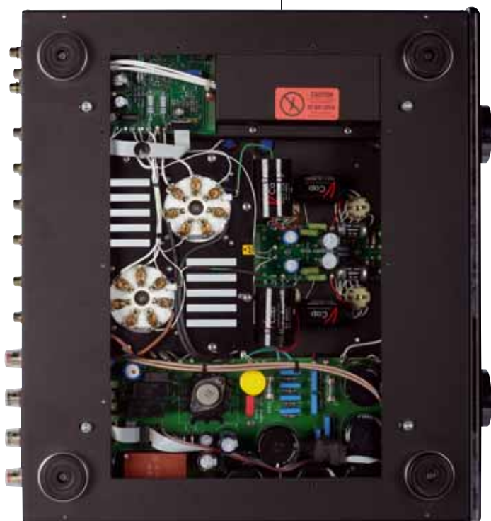
Eine Mischung aus freier Verdrahtung und Platinenlayouts präsentiert der Blick von unten in den Aura
